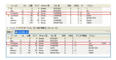
変更後の定義で firstName フィールドのサイズが 20 であるのに対し、元の定義ではサイズが 30 になっていることに注目してください。元の定義では、[プレビュー] 列にファースト ネームの "Joe" とラスト ネームの "Smith" の両方が表示されています。変更後の定義ではこのフィールドのサイズが小さくなり、[プレビュー] 列にはファーストネームのみが適切に表示されています。
